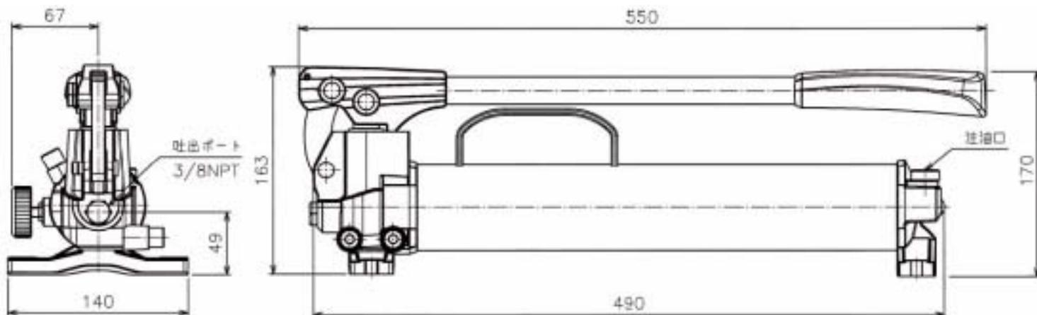
最高吐出圧力 70MPa (700kg/cm<sup>2</sup>)、 低圧吐出圧力 3.4MPa (34kg/cm<sup>2</sup>)、 低圧吐出量 16.4cc/st
